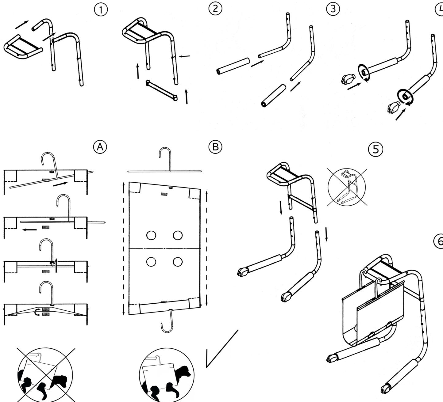
1. Insérez la partie supérieure avec les tubes du dos.
